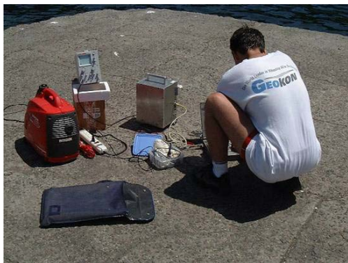
Figura 8 Medições de vibração com Pias e gráfico de acelerações versus tempo
